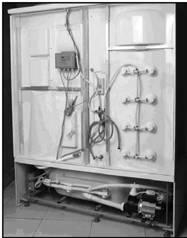
12. Schließen Sie den Dampferzeuger an die Dampfdüse, Wasserein- / auslaß (Abb. 6) an:
